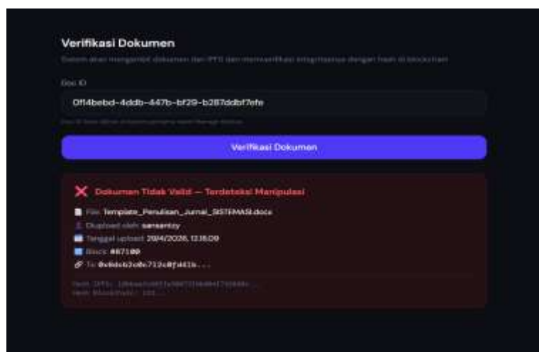
Gambar 6 Hasil verifikasi setelah nilai hash pada database diubah secara manual
